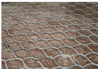
图 3 格宾网示意图 Fig.3 Gabion meshes
